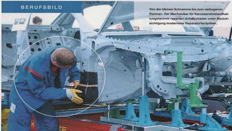
Von der kleinen Schramme bis zum verbogenen Rahmen. Der Mechaniker für Karosserieinstandhaltungstechnik repariert Unfallchäden unter Berücksichtigung modernster Reparaturtechniken.
